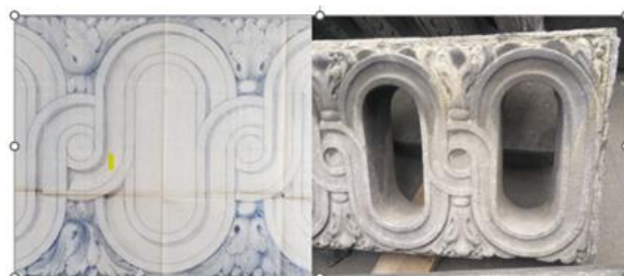
Détail grandeur d'exécution de la balustrade du square de François Malfait reu Ravenstein, décembre 1921 (AVB, Fonds TP, n° 56466, feuille n° 5.) et fragment de la balustrade démontée (2022)
